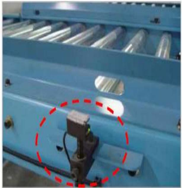
▶ Conveyor Sensor류 설치
