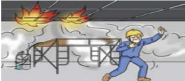
용접 및 용단 작업 시 발생하는 불티에 의한 화재
