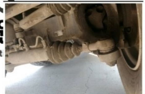
30 4축 조향실린더 상태 확인
