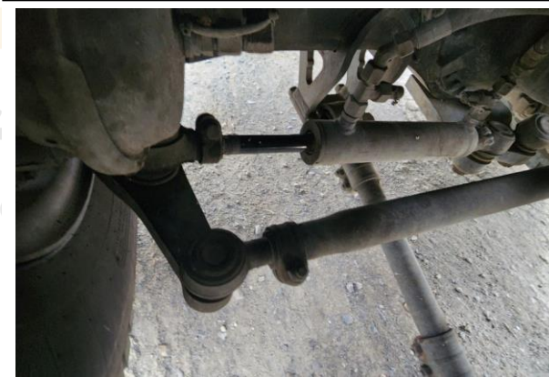
29 조향실린더 상태 확인
