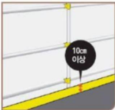
위험을 방지할 수 있는 망을 설치한 경우 발끝막이판 설치 제외
