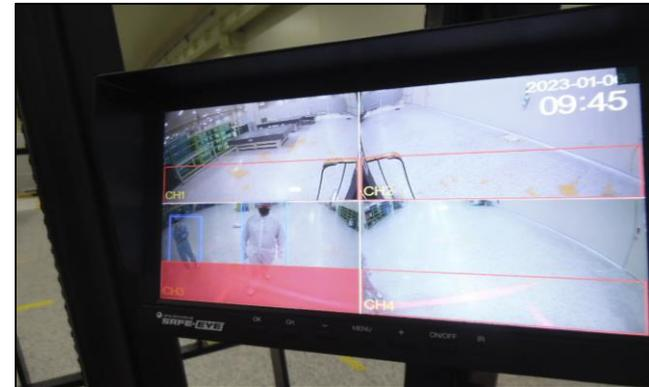
**위험상황 감지 시 경고음 발생 및 화면에 적색 경고 표시**
