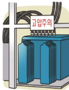
고전압 위험 경고 표지판 설치
