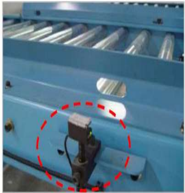
▶ Conveyor Sensor류 설치
