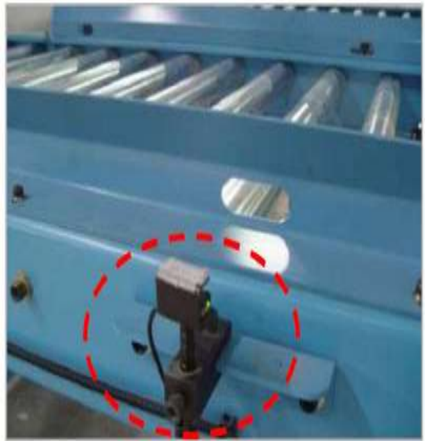
▶ Conveyor Sensor류 설치
