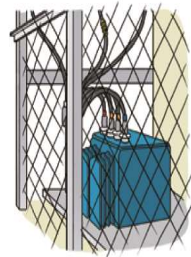
변압기 방호울 설치
